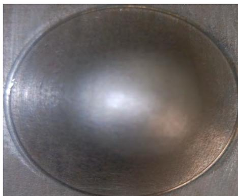
**Figura 3.** Embutimento Erichsen da amostra referente ao material original proveniente da usina.
