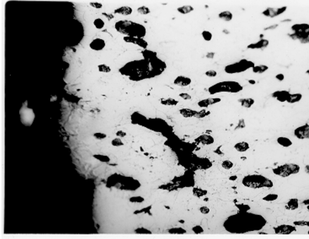
Figura 7. Micrografia ótica da seção ortogonal à fratura da liga 2. Nital 2%. (120x)
