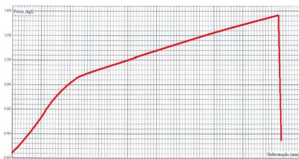
**Figura 3** - Curva típica força x deformação obtida no ensaio de tração do compósito de PDMS reticulado quimicamente.
