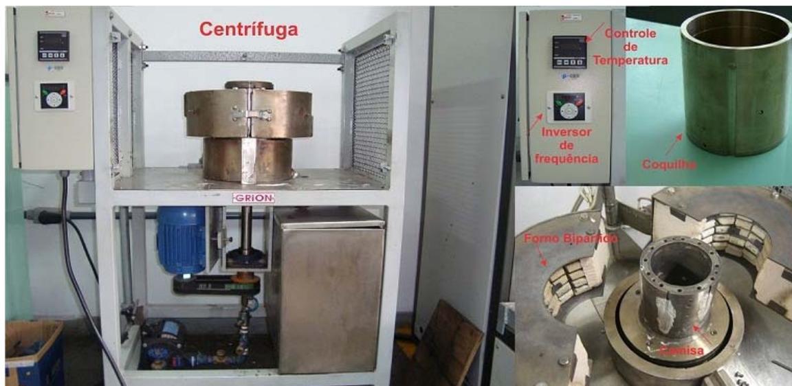
Figura 2. Representação da centrífuga laboratorial do Centro de Desenvolvimento de Materiais Metálicos da FEI (CDMatM – FEI).
