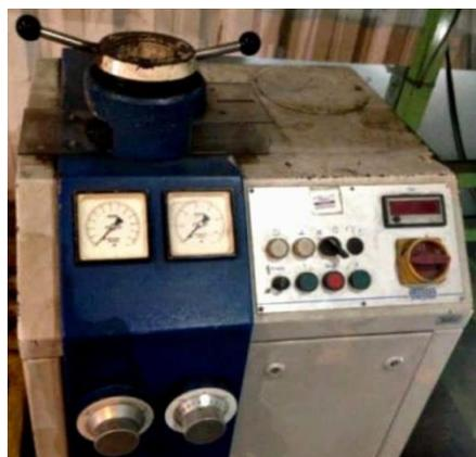
Figura 5 – Prensa para ensaio de embutimento Erichsen.
