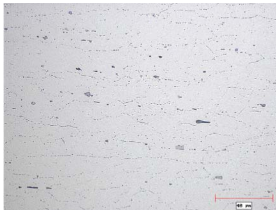
Figura 6: Microestrutura do material após teste de forno 60°C por 480 horas.
