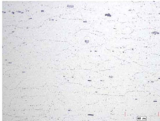
Figura 5: Microestrutura do material após teste de forno 50°C por 480 horas.
