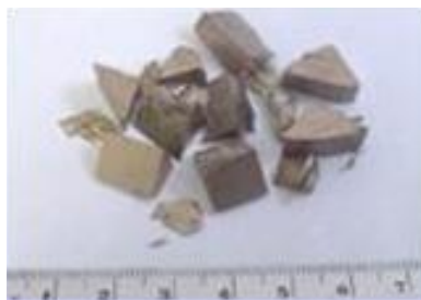
Figura 1 – Amostras da liga Cu-Al-Ni para serem refundidas em forno a plasma.
