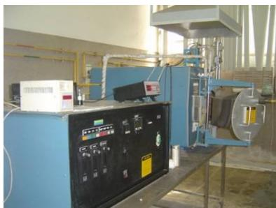
**Figura 3.** Forno de tratamento térmico.
