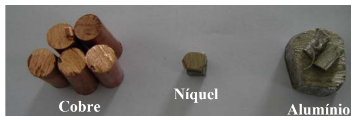
Figura 1. Forma dos materiais utilizados para a obtenção da liga de Cu-13,5Al-4,0Ni (% peso) com memória de forma.
