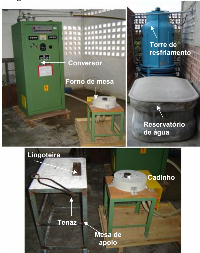
Figura 2. Conjunto de equipamentos que forma a instalação de fusão por indução utilizada neste trabalho.
