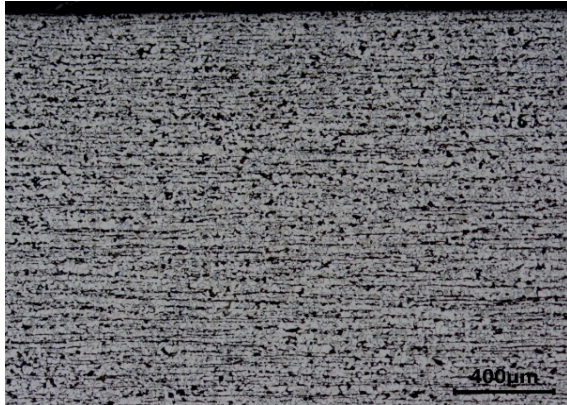
Figura 6: Micrografia do esboço com 30 mm de boa tenacidade. Ataque de nital 4%, aumento de 50 vezes, superfície.
