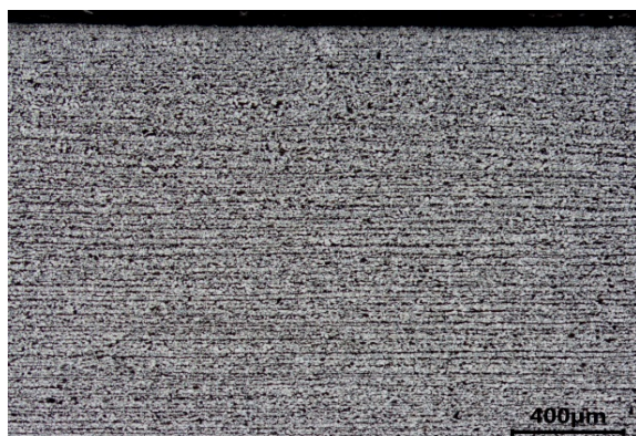
Figura 2: Micrografia do esboço com 15 mm de boa tenacidade. Ataque de nital 4%, aumento de 50 vezes, superfície.
