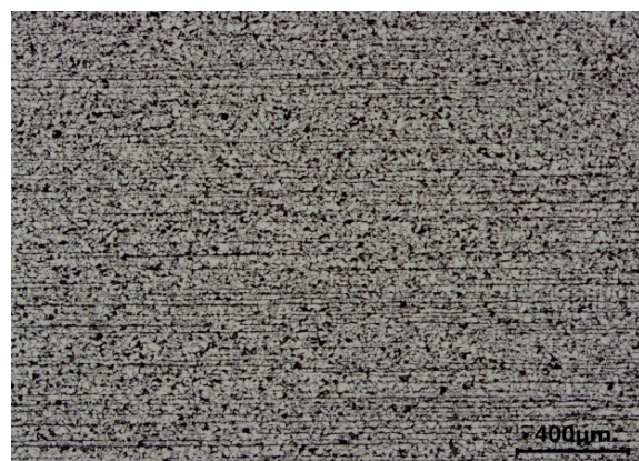
Figura 5: Micrografia do esboço com 15 mm de tenacidade moderada. Ataque de nital 4%, aumento de 50 vezes, 1/4 da espessura.
