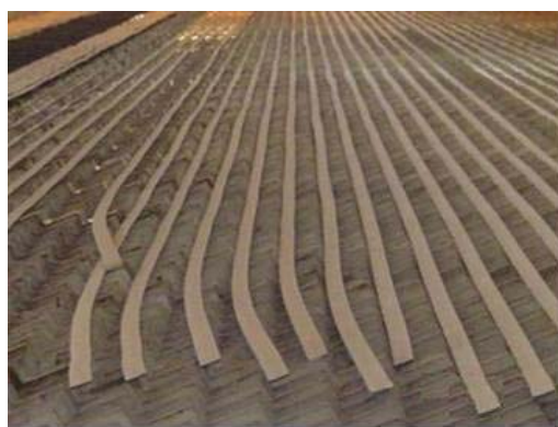
Figura 2 – Empeno na barra chata 1 5/8" x 5/16" do aço SAE 5160.
