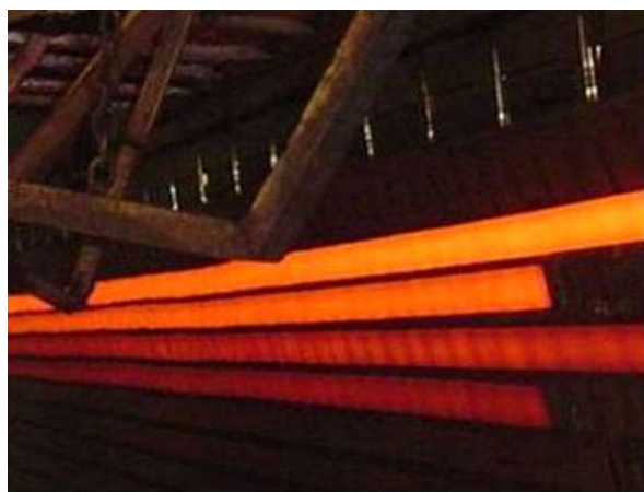
Figura 6 – Manchas escuras ao longo da barra devido as diferentes taxas de resfriamento.
