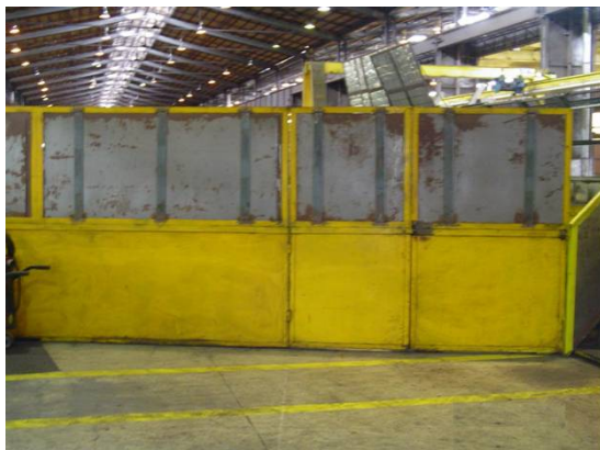
Figura 7 – Proteção das laterais do leito realizada com chapas de alumínio.
