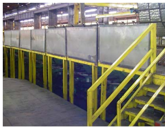
Figura 7 – Proteção das laterais do leito realizada com chapas de alumínio.
