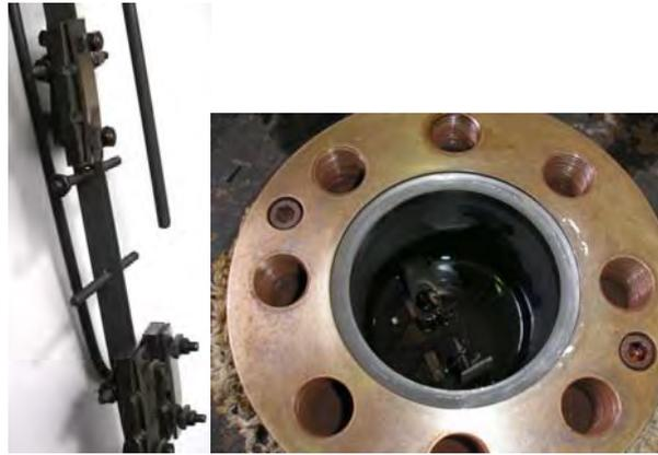
**Figura 11.** Dispositivo de montagem das amostras e sua posição na autoclave
