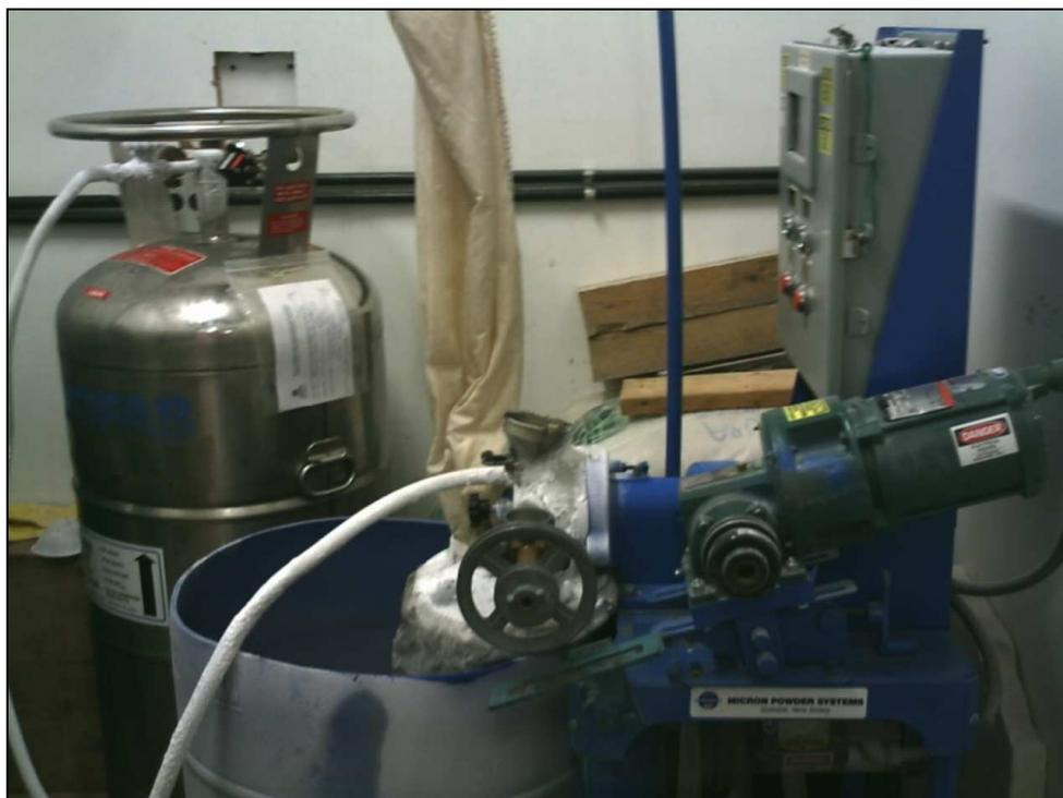
**Figura 1:** Moinho criogênico acoplado ao cilindro de nitrogênio líquido – [Foto retirada na unidade existente no laboratório de materiais da Universidade Federal de São Carlos, São Carlos – SP].
