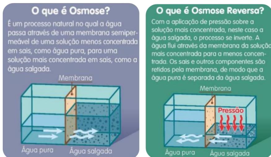
Figura 3 – Descrição da Osmose reversa, tecnologia escolhida de dessalinização de água do mar na AMT
