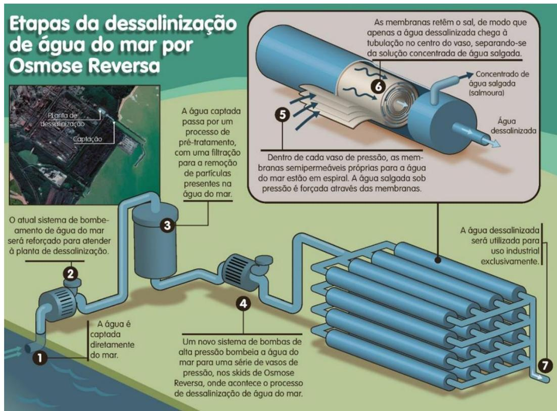
Figura 4 – Etapas da Dessalinização de Água do Mar por Osmose Reversa
