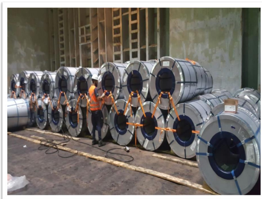
Figura 5. Peça de bobinas no eixo horizontal
