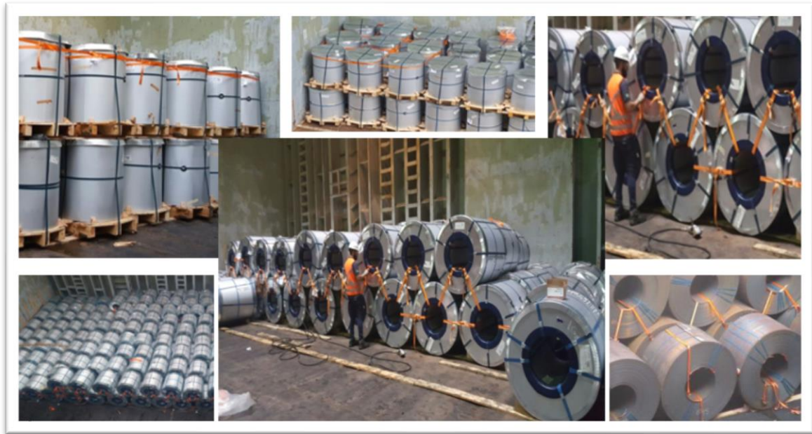
Figura 8. Processo com cintas de poliéster e fivela de aço
