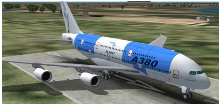
Figura 2 – Aeronave Airbus A380: em azul os painéis de Glare utilizados na confecção da fuselagem superior.
