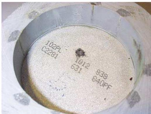
Figura 6. Resistores não lineares danificados.
