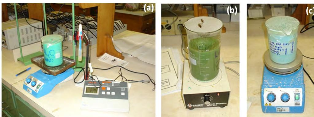
**Figura 3.** (a) Aparato para o processo de eletrodeposição (aquecimento, agitação, controle de pH); (b) e (c) Suspensões (soluções para eletrodeposição contendo partículas dispersas dos óxidos).
