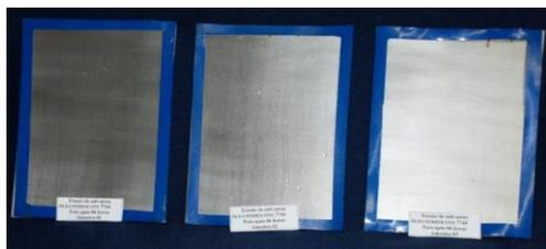
**Figura 43**- Amostras após 6 horas de Salt spray ( Fonte: Laboratório de Corrosão, CSN)
