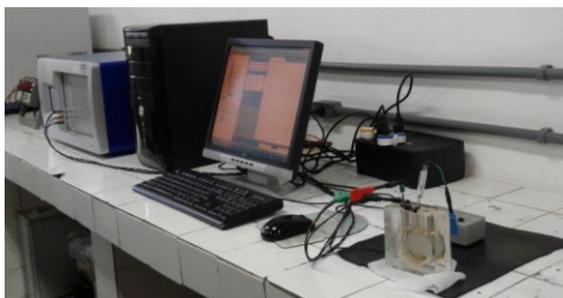
Figura 2-Célula Eletroquímica usada no estudo ( Fonte: Universidade Federal Fluminense)
