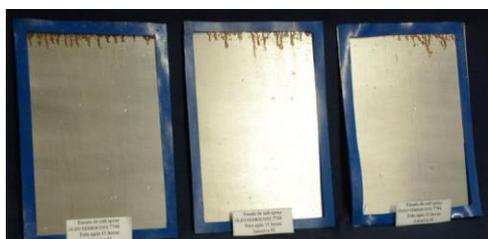
**Figura 45**- Amostras após 11 horas de Salt Spray ( Fonte: Laboratório de corrosão, CSN)
