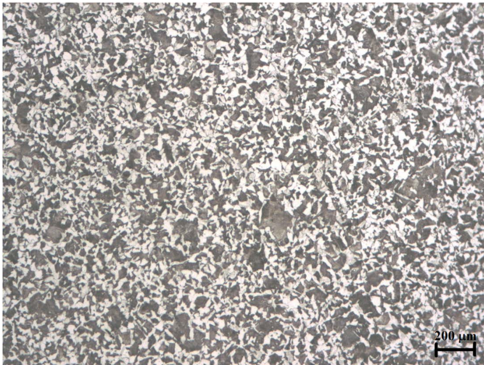
Figura 7. Micrografia do corpo de prova 4 (com adição de Nb, sem tratamento térmico e com resfriamento controlado), atacado com Nital 4% e com 100x de aumento.
