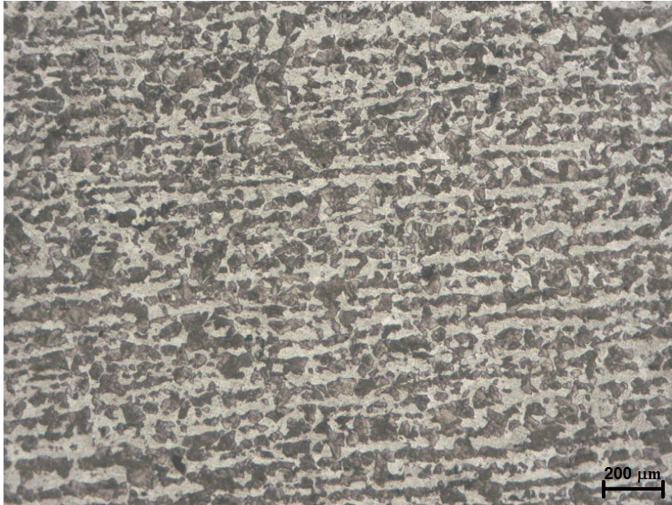
Figura 6. Micrografia do corpo de prova 3 (com adição de Nb e sem tratamento térmico), atacado com Nital 4% e com 100x de aumento.
