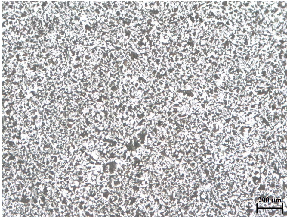
Figura 4. Micrografia do corpo de prova 1 (sem adição de Nb e normalizado), atacado com Nital 4% e com 100x de aumento.
