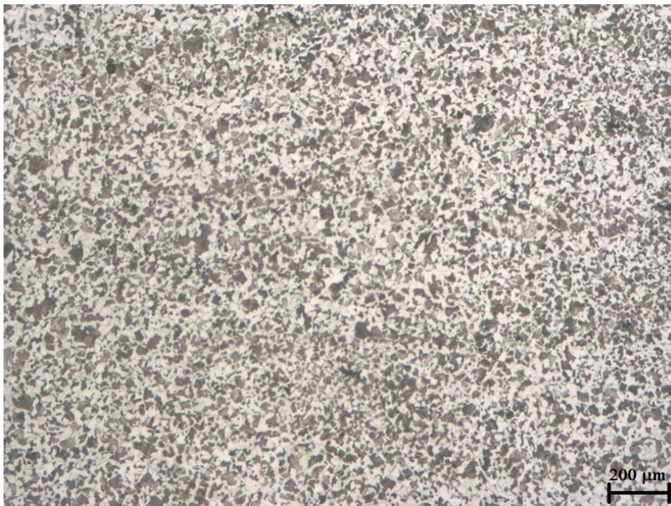
Figura 5. Micrografia do corpo de prova 2 (com adição de Nb e normalizado), atacado com Nital 4% e com 100x de aumento.
