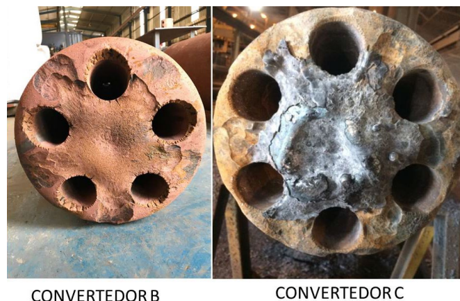
Figura 3 - Representação de bicos utilizados nos convertedores abordados que sofreram desgastes por rebote.
