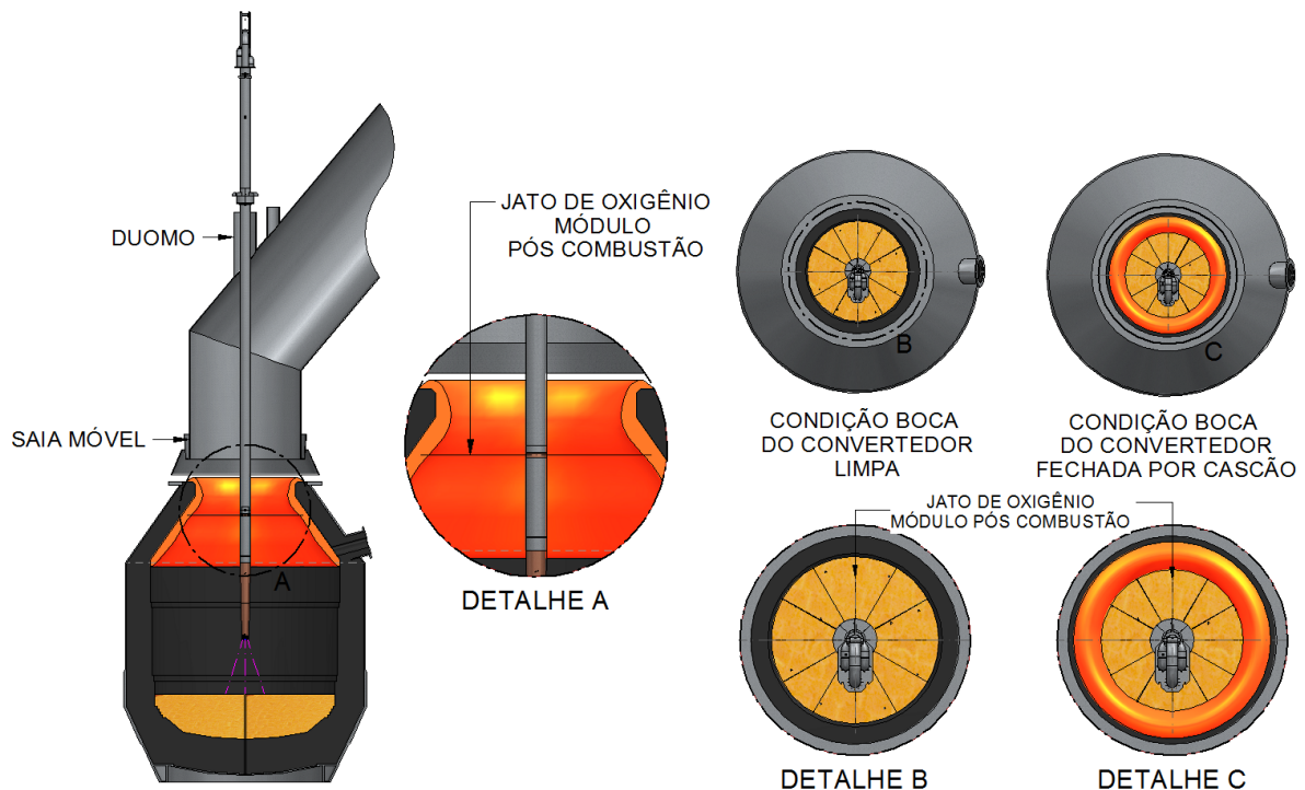
Figura 11 - Conceito da de tecnologia Slagless Clean Up ® .
