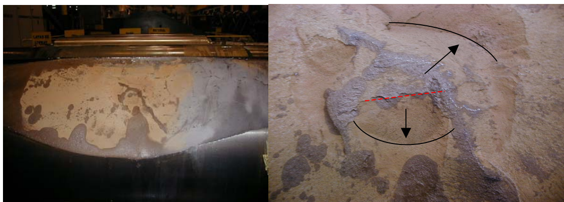
Figura 17 – Morfologia de lascamento de cilindro alto-cromo
