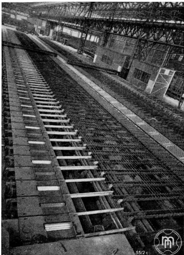
Fig. 20 — Leito a pentes eleváveis. Vista do sistema de evacuação e da mesa de rolos de saída.
