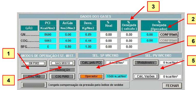
Figura 7. Tela de seleção de gases da estação de mistura
