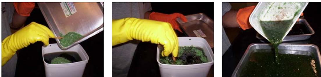
**Figura 3** – Fabricação do compósito.
