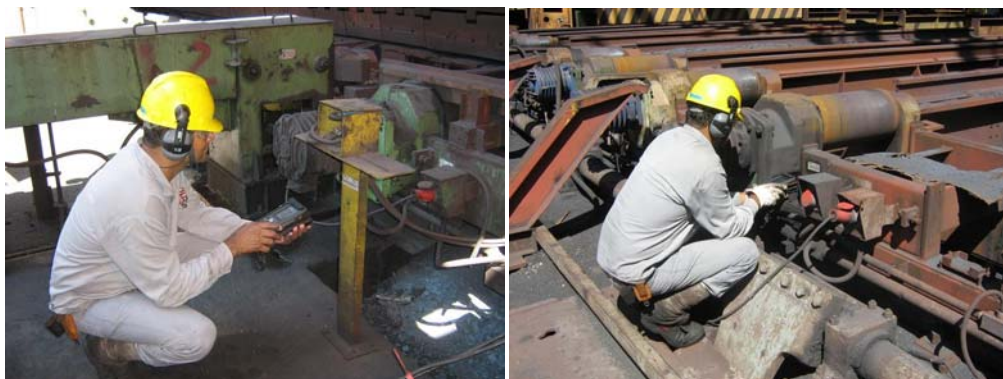
Figura 4 – Utilização de coletores de dados para registro das inspeções e tratamento das anomalias em campo.
