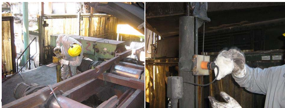
Figura 2 – Teste detectivo sendo realizado em dispositivos de controle e segurança
