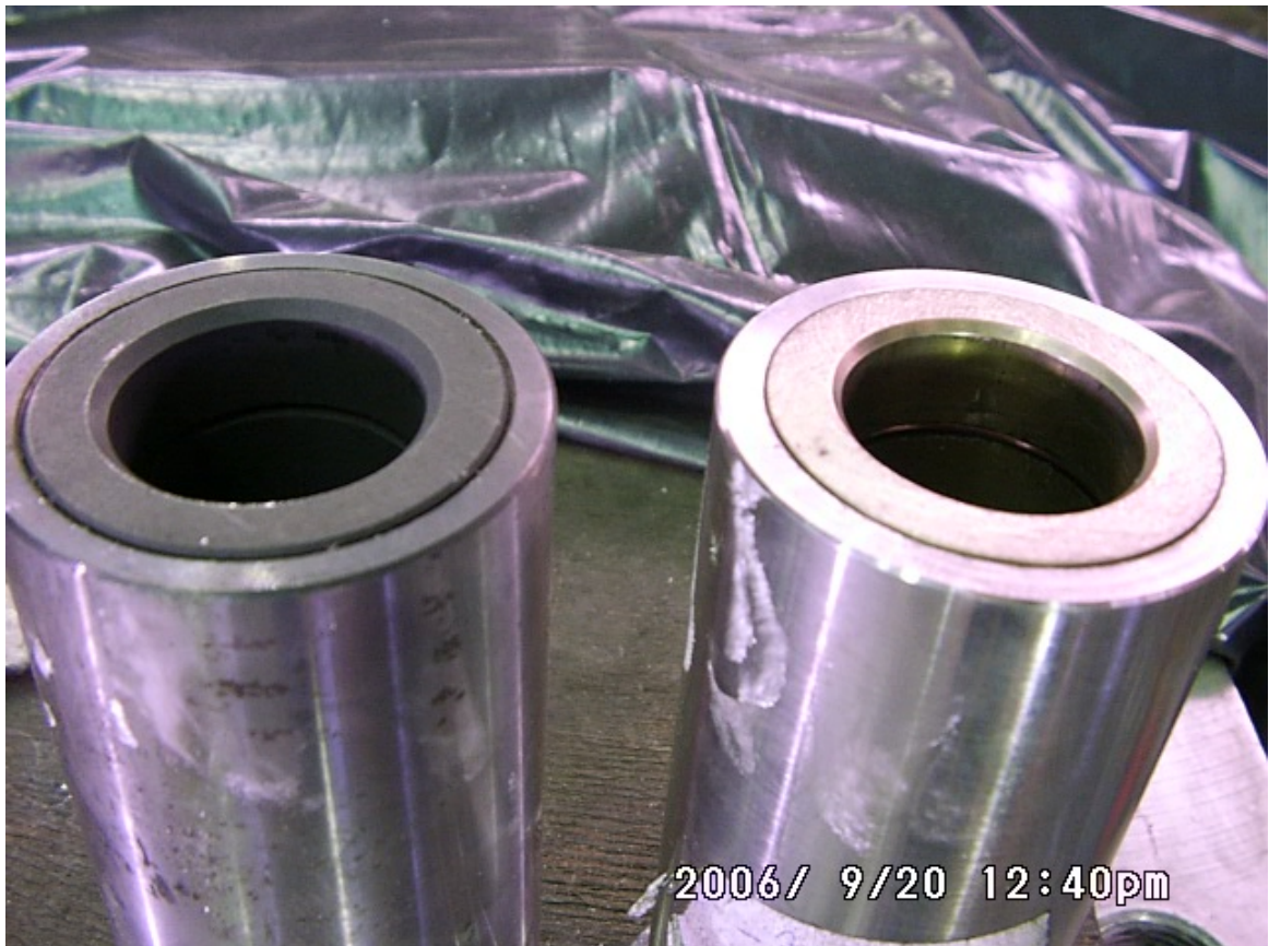
Figura 13 – bucha de grafite e bucha de bronze sinterizado
