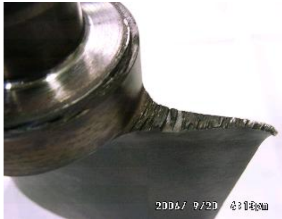
Figura 16 – palheta do estator danificada pelo contato com a carcaça
