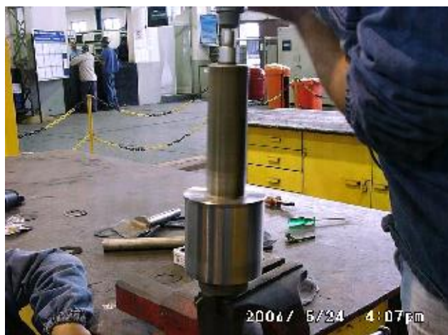
Figura 10 – preparação do colar da palheta para a lapidação.
