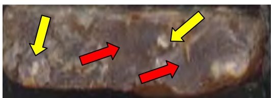
Figura 6: Superfície de fratura de compósitos híbridos nas proporções de 25% Fibras de Sisal por 75% de resíduo de Angelim.
