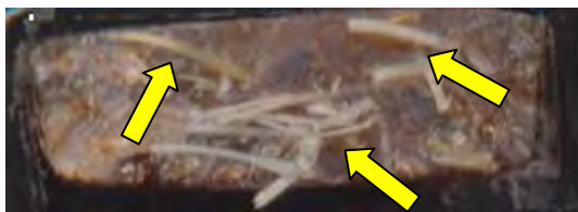
Figura 4: Superfície de fratura de compósitos híbridos nas proporções de 75% Fibras de Sisal por 25% de resíduo de Angelim.
