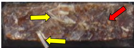
Figura 5: Superfície de fratura de compósitos híbridos nas proporções de 50% Fibras de Sisal por 50% de resíduo de Angelim.
