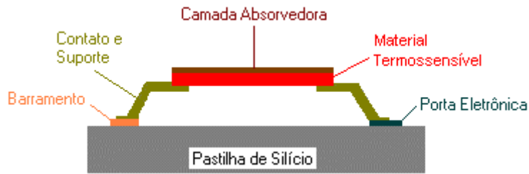
Figura 1 - Configuração básica de um microbolômetro, elemento de uma matriz de termodetectores.
