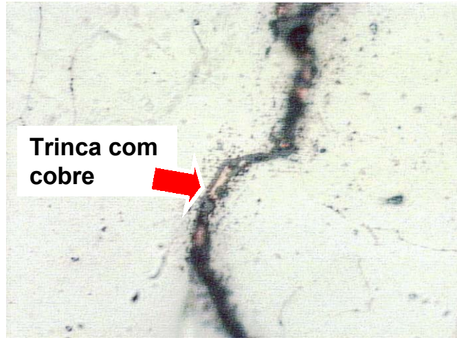
Figura 5. Exemplo de trinca “recheada com cobre”, observada em amostra de placa antes do enformamento. Micrografia ótica. Seção longitudinal. Superfície polida e atacada com Nital 2%. ~1400x.
