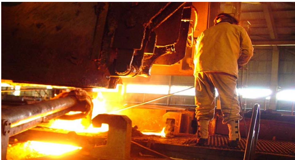
Figura 4 - Medição da temperatura do aço líquido no distribuidor com lança de medição manual.
