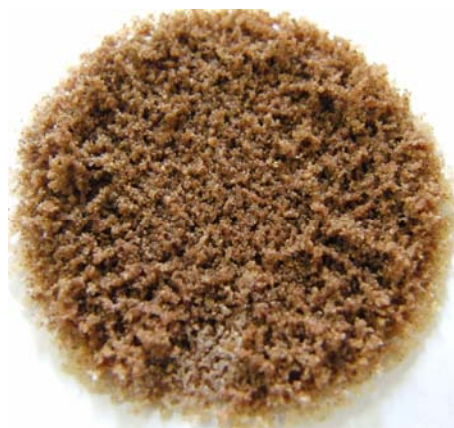
Figura 4. Meio filtrante obtido após Processo de Rotomoldagem
