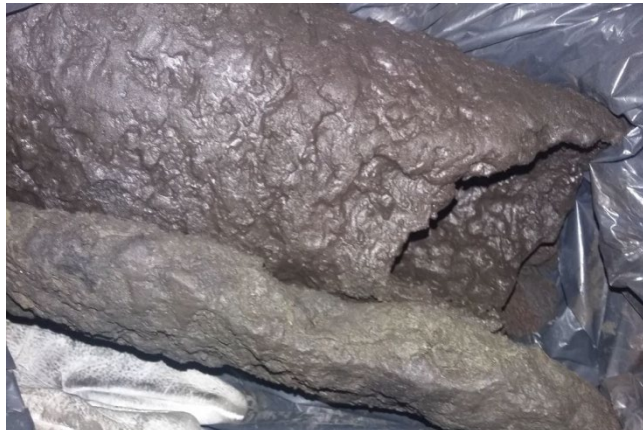
Figura 3. Depósito retirado da tubulação de alimentação do Scrubber 02.
