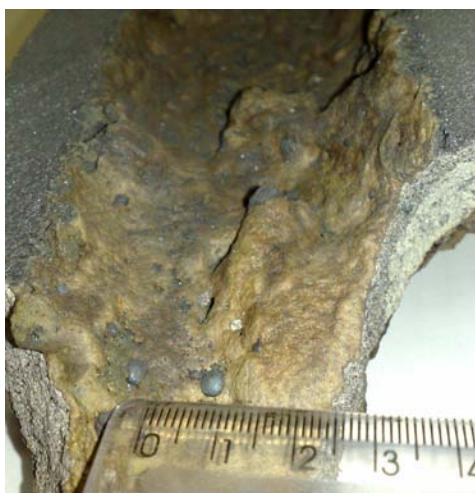
Figura 2 – Válvula submersa com obstrução parcial durante o lingotamento do aço P409A.
