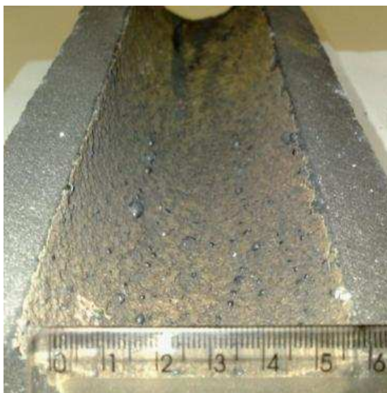
Figura 6 – Válvula submersa sem obstrução, lingotamento do aço P409A com relação de Si/Ti mais elevada.
