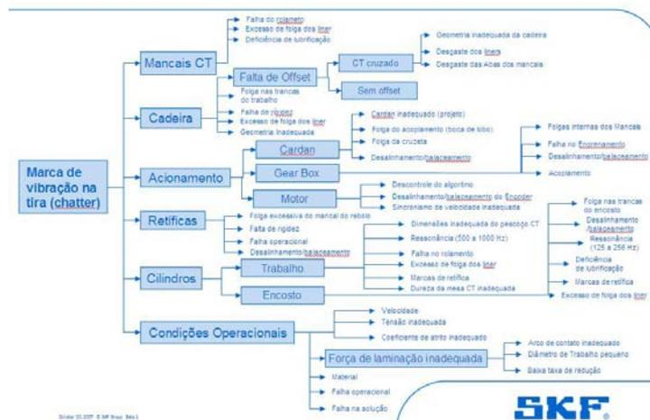
Figura 1 – Árvore de falhas potenciais do *Chatter*.<sup>(2)</sup>
