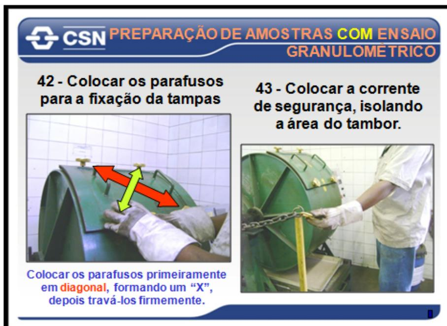
Figura 10. Material de Treinamento – Preparação de amostras.
