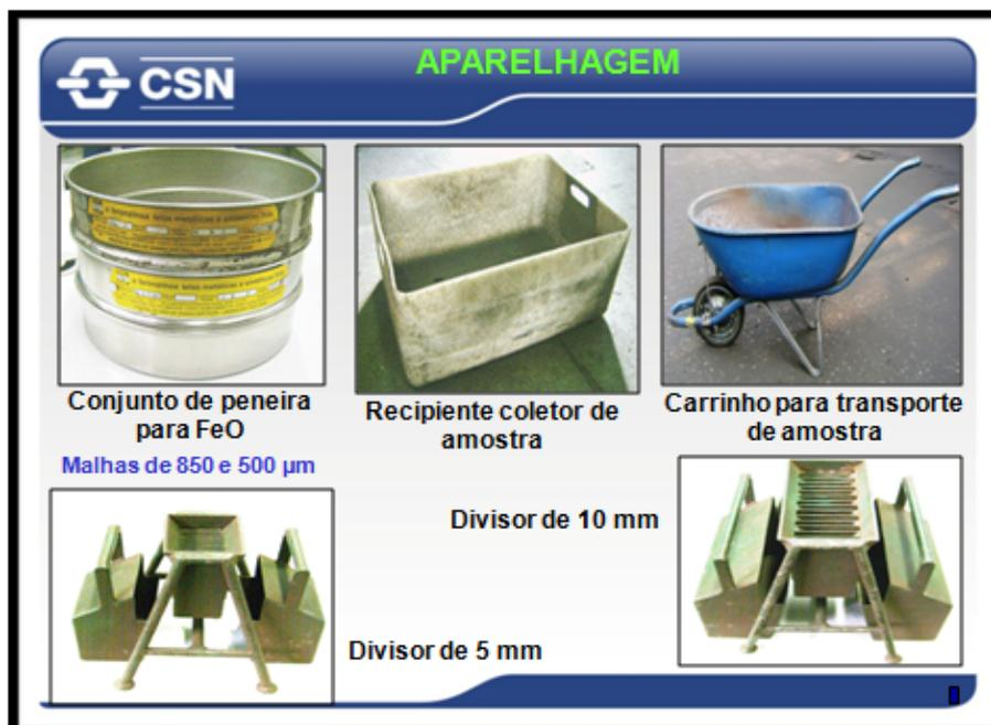
Figura 9. Material de Treinamento – Aparelhagem.
