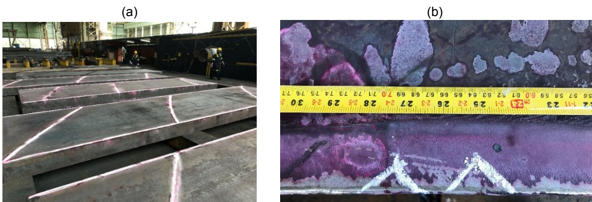
Figura 5 – Inspeção superficial de placas visando identificar defeitos superficiais (a) especialmente trincas de quina (b).
