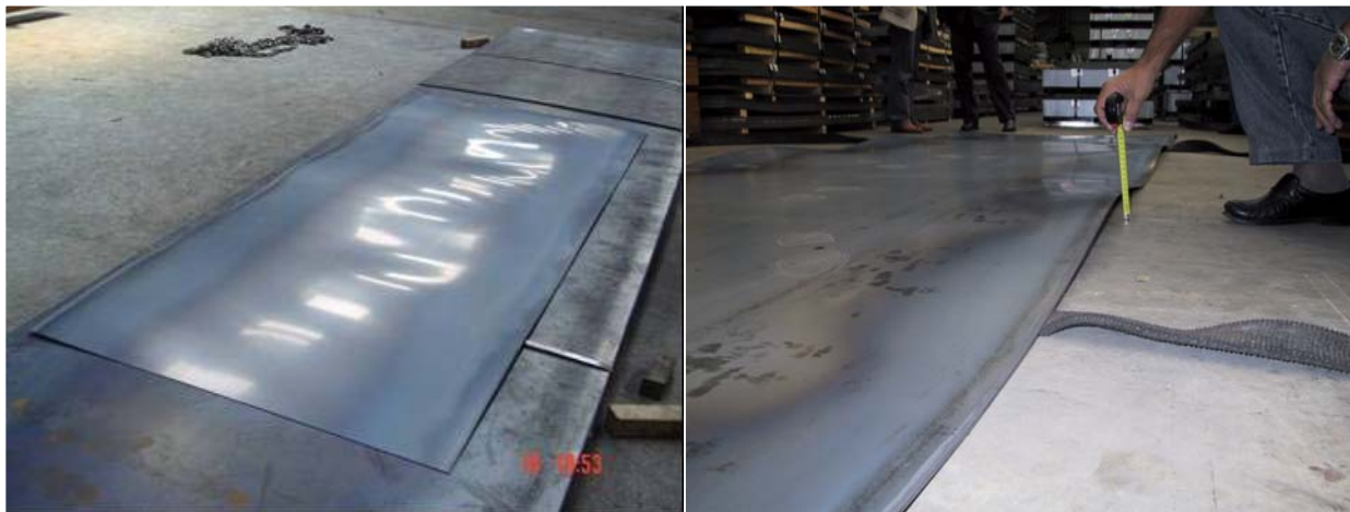
Figura 5. Fotos de bobinas relamadas por clientes com ondulações centrais (2,00 x 1.200 e com ondulações de borda (2,65 x 1.500mm), respectivamente
