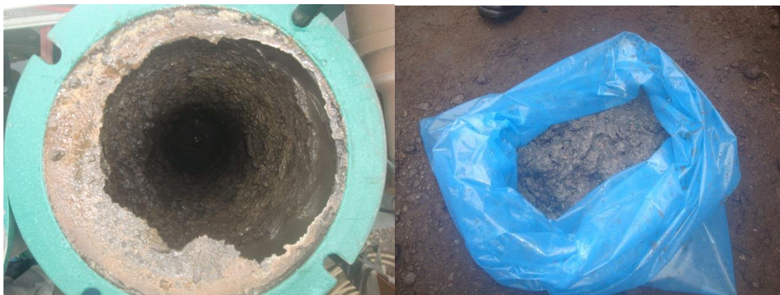
Figura 11 – Reator incrustado e material recolhido na limpeza dos reatores.
