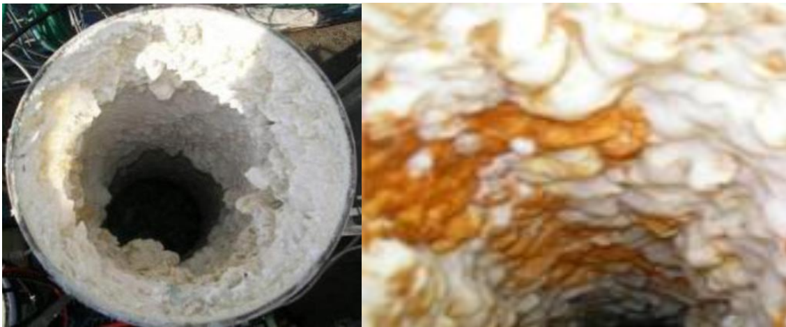
Figura 9 - Reator aberto com material que foi recolhido do processo Incrustação, Fe, Mn e outros orgânicos capturados no interior do reator
