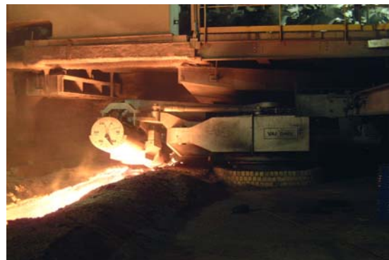
Fig.04-Proximidade do canhão ao canal 1500°C para realização da operação
