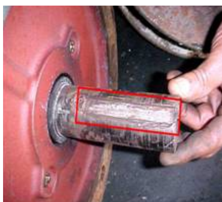
Figura 8. Avarias na Chaveta do Motor.
