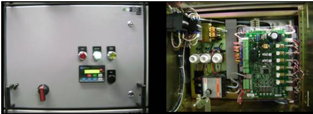
Figura 10. Softstarter Frontal e Circuito Interno.
