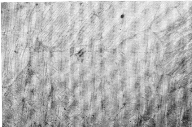
Fig. 16 — Cristal de zinco atacado com reativo preferencial, mostrando bandas de deformação e diferentes orientações cristalinas (230×).
