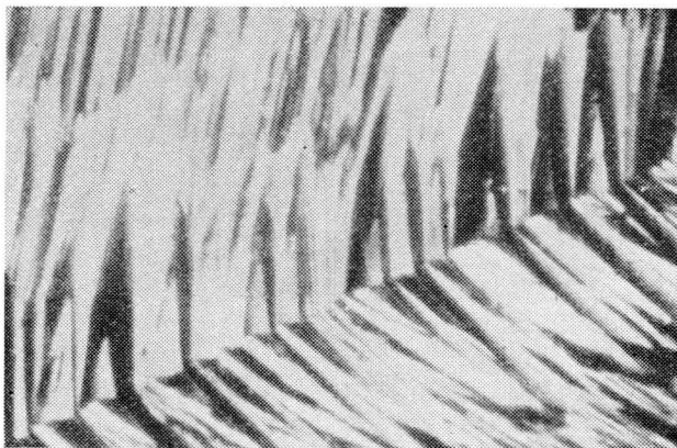
Fig. 7 — Mesma macla da figura 6 vista na direção (1, 1, 0) ( 230\times ).
