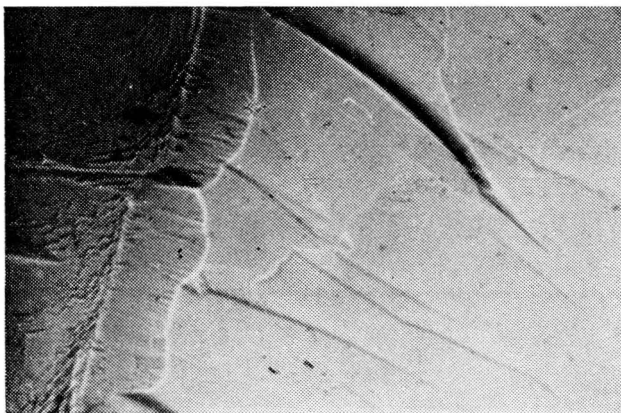
Fig. 3 — Mesma superfície da figura 2, após 30 minutos no polidor químico nº 2 (230×).
