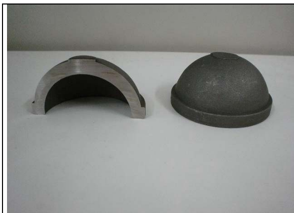
Figura 1. Prótese de acetábulo da liga F-75.
