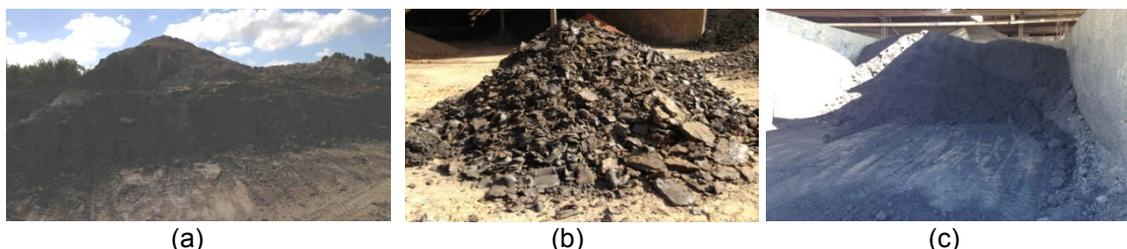
**Figura 1.** (a) Resíduo de rocha; (b) Resíduo de massa argilosa crua; (c) Lama de alto forno
