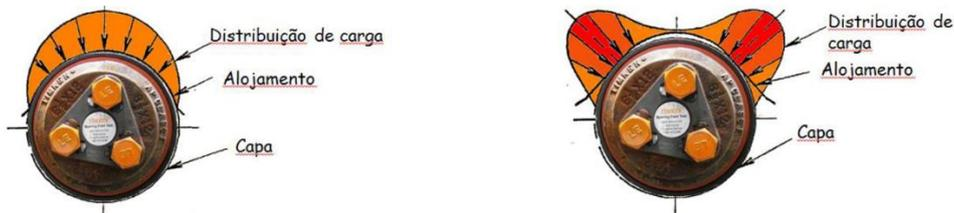
**Figura 8.** Distribuição de carga nos rolamentos.
