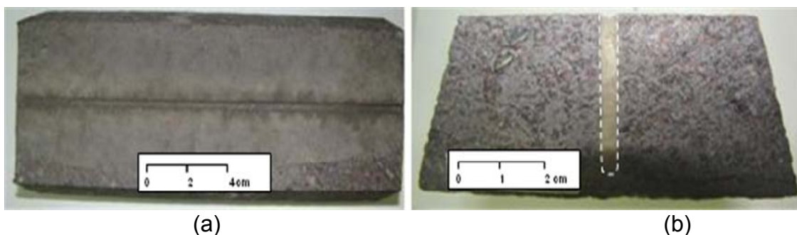
Figura 1. Fotografias do corpo-de-prova de tijolo \text{Al}_2\text{O}_3\text{-SiC-C} para ensaio de ataque por escória em forno rotativo: (a) superfície sujeita à corrosão evidenciando o entalhe; e (b) seção transversal do corpo-de-prova destacando o entalhe com argamassa.
