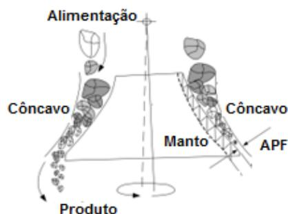
Figura 1. Princípio de um britador cônico
