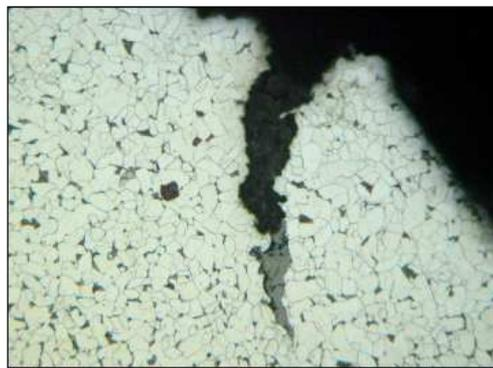
Figura 2 (b) - Aspecto metalográfico das trincas de profundidade de 0,4 mm e carepa no interior. Ataque nital 2% e 100X de aumento.
