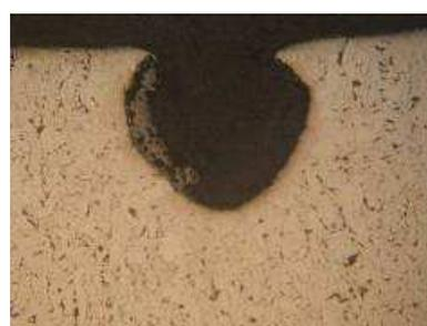
**Figura 1 (b)** - Aspecto metalográfico dos *pin holes*. Ataque nital 2% e 100X de aumento.
