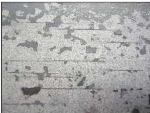
Figura 2(a) - Aspecto das trincas superficiais de reduzida extensão e profundidade em uma barra laminada.
