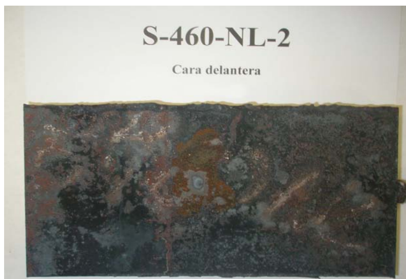
Figura 8. Vistas anterior de uno de los aceros ensayados S460NL.
