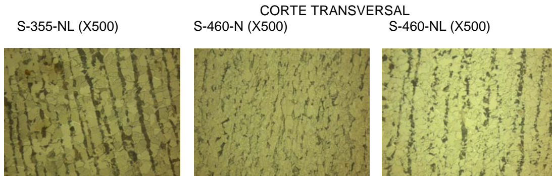
Figura 1. Micrografía comparativa de los aceros ensayados.
