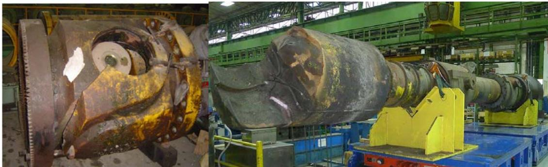
**Figura 05.** Exemplos de Trincas ocorridas nos acoplamentos Lado Rolo de uma Junta TipoCardan e uma Junta tipo Sapata
